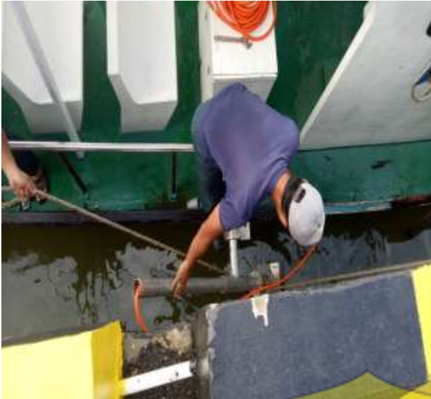
Gambar 18. Pemasangan Tranducer di sisi kapal Profiller
