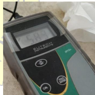
Pengukuran pH meter
