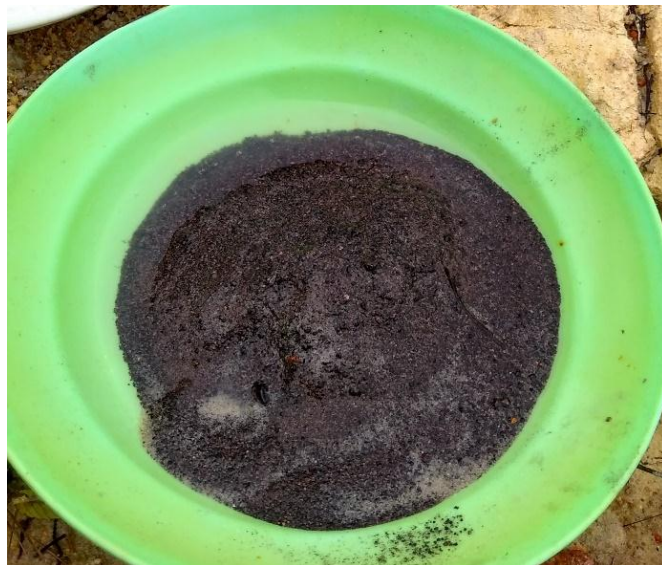
Gambar 5.5. Kenampakan mineral kasiterit yang telah didulang oleh para penambang
