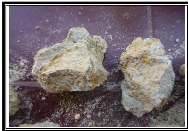
Gambar 5.2 Sampel batugamping Foraminiferal packstone pada lokasi pengamatan STA R.11.02.
