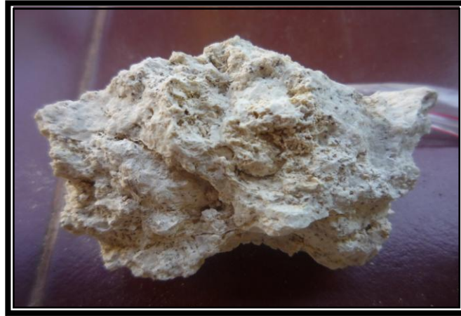
Gambar 5.7 Sampel batugamping fasies Coral packstone pada lokasi pengamatan STA R.11.06.
